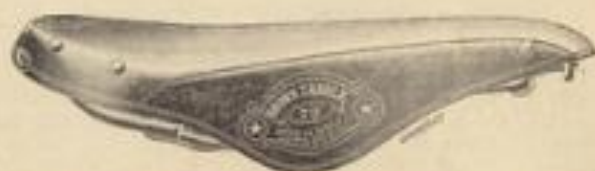
2880. Selle de course de grand luxe Brown 79, cuir qua- lité extra-supérieure. Ressorts 2 fils nickelés. Longueur 23 cm., chemise intérieure de renfort. Prix : 42 75 Ressort 2 fils rivé avec croissant. — 6 » Ressort seul nu. — 4 50
