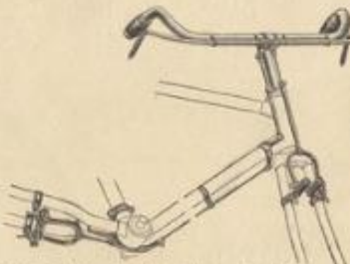
1819. Guidon double frein anglais de luxe, avec attaches brasées, freins galbés, boulonnerie décollée, ressort avec attache à l'entraîneuse.
