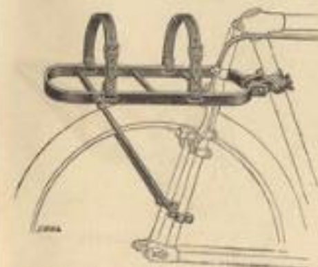
2764. Porte-bagages "Le Stable" se fixent sur le tube de cadre et sur les montants arrières au moyen de colliers. 12 50
