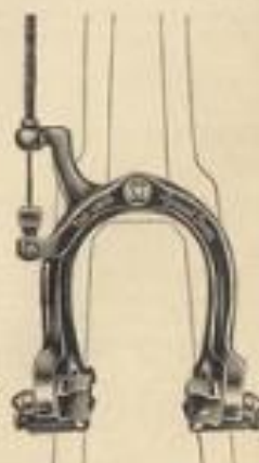
1739. Frein " The Unic " Grand luxe, à chape oscillante, en acier estampé à froid avec poignée réglable, ébouite. Avant ou arrière route.
