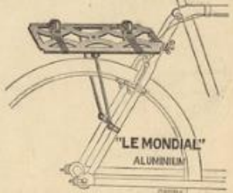
2766. Porte-bagages Le Mondial en aluminium poli, montants acier. Dimensions 280 x 150. Prix : 25 25
