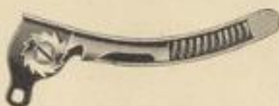
Coupe montrant le dispositif du levier réglable de frein The Unic
