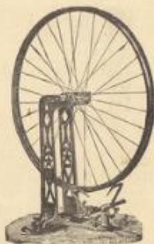
3282. Appareil à centrer les roues. Ensaillé. Prix: 84 »
