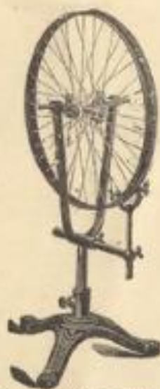
3280. Appareil à centrer les roues, n° 11, sur pied. Prix: 98 »
