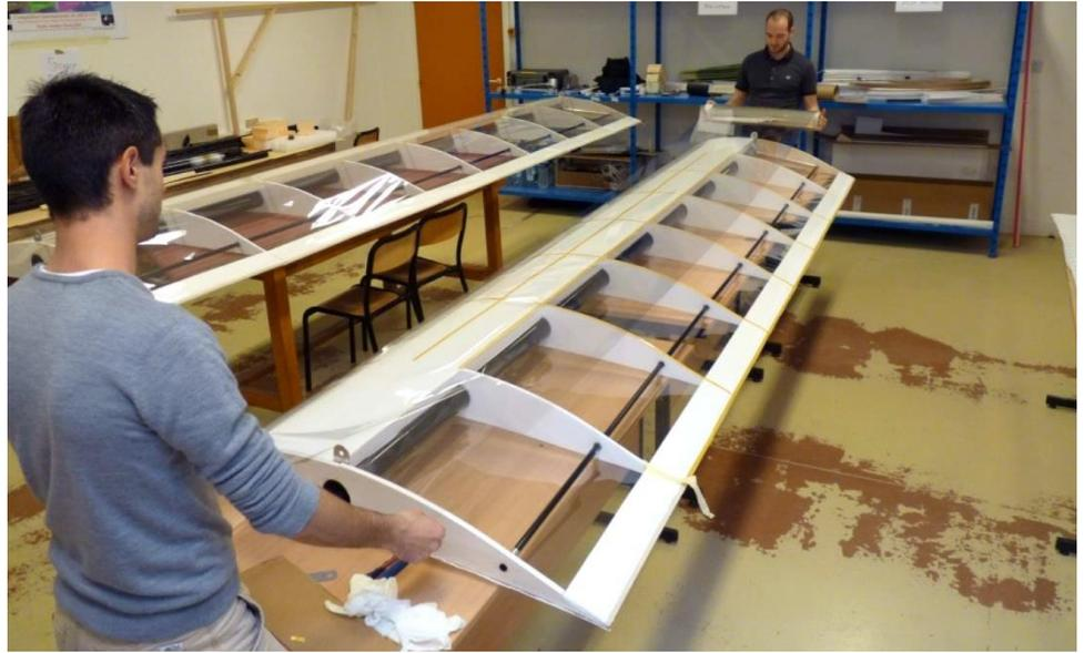
Figure 27 : Pause du Mylar sur un tronçon d'aile (@équipe HPA 2014)
