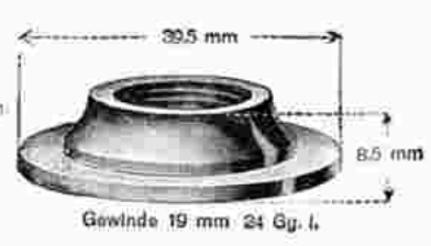
Gewinde 19 mm, 24 Gg. I. Nr. 19903 Für W. K. C. . . . . . M
