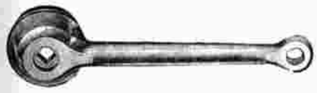
46 mm Glockenweite, 55 mm Kettenradgewinde Rechte Kurbel Nr. 16020 178 mm lang. M
