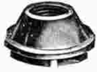
Gew. 6g. 24. Gew. Durchm. 10mm. Con. Lg. 12mm. Con. Durchm. 24mm. Nr. 20070 Für Wanderer . . . M
