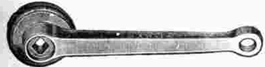
Nr. 16012 Rechte Kurbel 46 mm Glockenweite 52 mm Kettenradgewinde M
