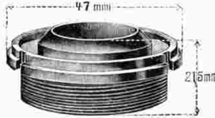
Loch 23 mm Gewinde 39,2 mm 25 Gg. r.
