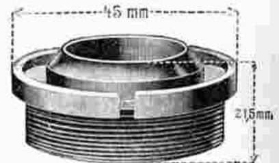
Loch 23 mm Gewinde 39,2 mm 25 Gg. r.
