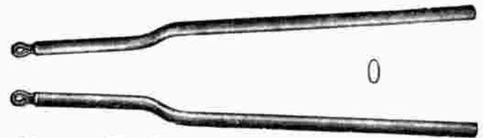
Obere Strebenrohre gekröpft, durchgehend oval
