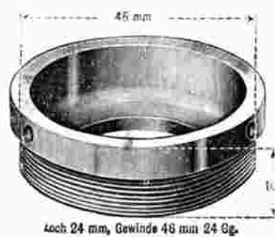
Nr. 18422 Für Fauber . Loch 24 mm, Gewinde 46 mm 24 Gg.
