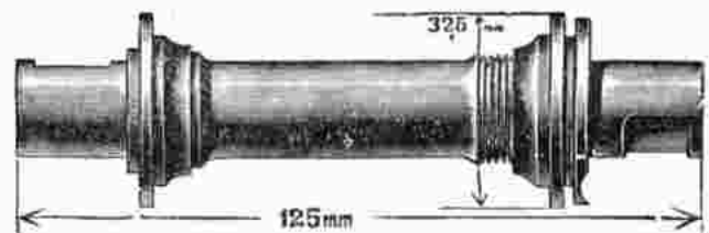
Nr. 16731 Für Bismarck, 130 mm lang, 36 mm Konendurchmesser
