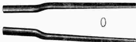
Nr. 9038 Untere Hintergabelrohre durchgehend, oval, gekröpft. . . . . per Paar ₰
