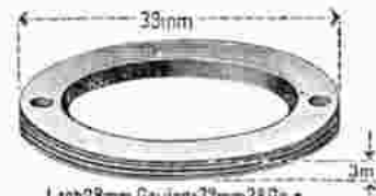
Loch 28 mm, Gewinde 39 mm 28 Gg. r.
