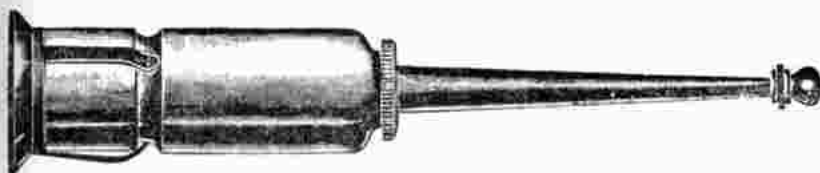
Nr. 6641 Sattelstütz-Oelkännchen ganz aus Messing mit Klemmvorrichtung, poliert und // vernickelt, sehr praktisch, 55 mm lang. per Stück . . . . . //
