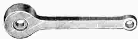
Nr. 16001 Linke Kurbel 48 mm Glockenweite M
