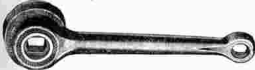
Linke Kurbel , 53 mm Glockenweite
