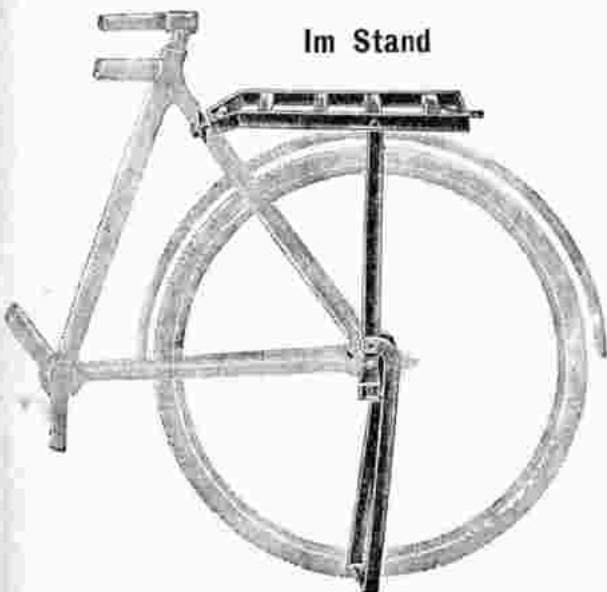
Nr. 5582 Hinterrad- Gepäckträger gleichzeitig Fahrradständer mit Sicherheitsschloß
