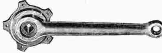
Rechte Kurbel 47 mm Glockenweite Nr. 15727 178 mm lang, für Herren Nr. 15728 165 mm lang, für Damen
