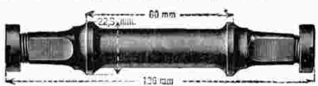
Für Claes-Pfeil mit vierkantigen Achsenden Nr. 16850 Achsenlänge 120 mm, Konenabstand 60 mm . . . . . M „ 16851 „ „ 111 „ „ „ 60 „ . . . . . M „ 16852 „ „ 117 „ „ „ 62 „ . . . . . M „ 16853 „ „ 123 „ „ „ 53 „ . . . . . M „ 16854 „ „ 123 „ „ „ 48 „ . . . . . M „ 16855 „ „ 118 „ „ „ 42 „ . . . . . M „ 16856 „ „ 140 „ „ „ 63 „ . . . . . M
