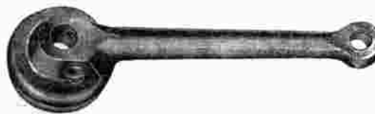
Nr. 16095 Rechte Kurbel für Keilbefestigung Glockenweite 52 mm, Kettenradgewinde 58 mm
