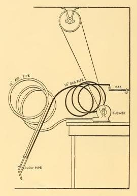
Fig. 12.—Convenient Blow Pipe.
