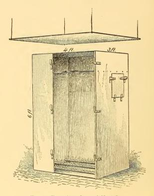
Fig. 2.-Enameling Oven of Sheet Iron.
