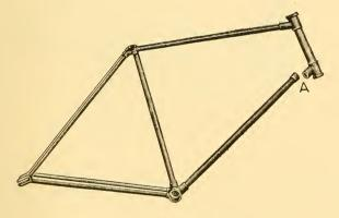
Fig. 1.-Socket Head Broken.
