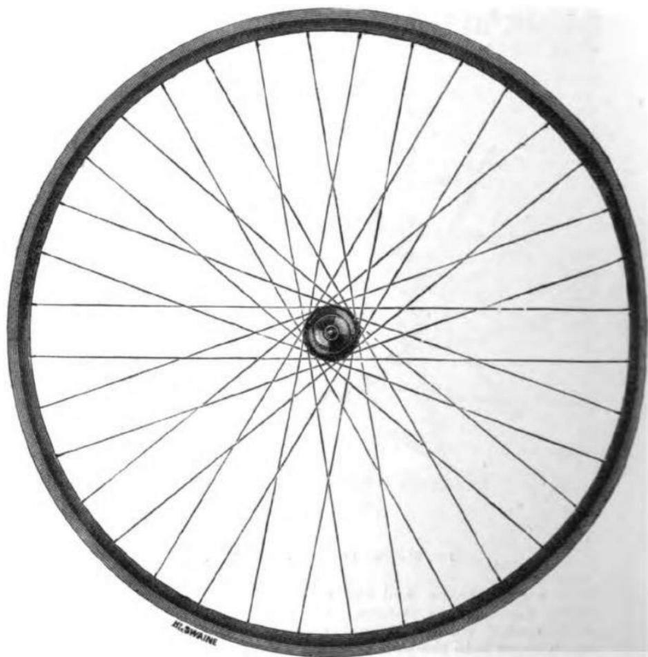
FIG. 23.—THE TRUE TANGENTIAL WHEEL.
