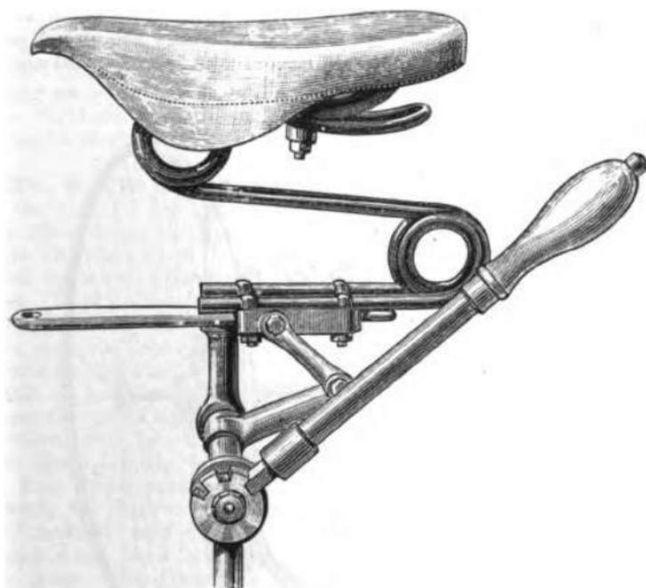
FIG. 2.—THE COVENTRY MACHINIST CO.'S PATENT SLIDING SEAT.
