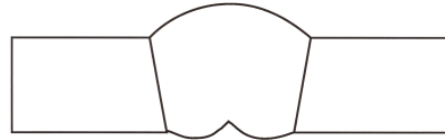
figuur 7.14 Effect van het optreden van een doorzakkende oxidehuid. De remedie is het breken van de las-kanten aan de onderzijde
