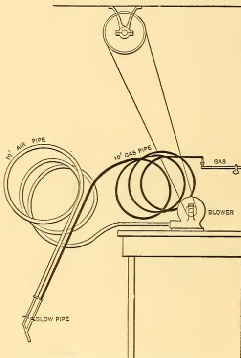
*Fig. 12.—Convenient Blow Pipe.*
